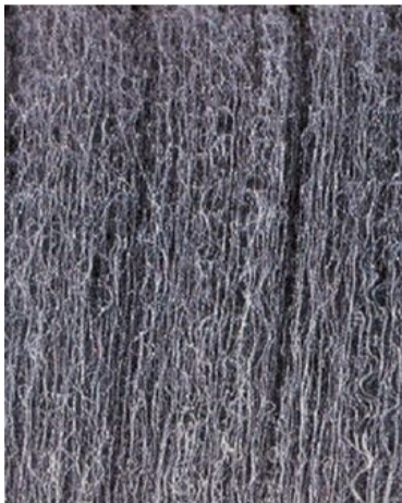
Paper zuntzak mikroskopioan. Norabide batean lerrokatzen dira
