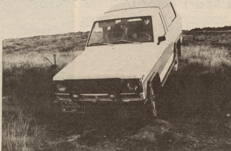
La altura al suelo es buena, pero el trozo de carrocería entre la rueda trasera y el parachoques es un handicap, cuando se trata de superar fuertes pendientes.
